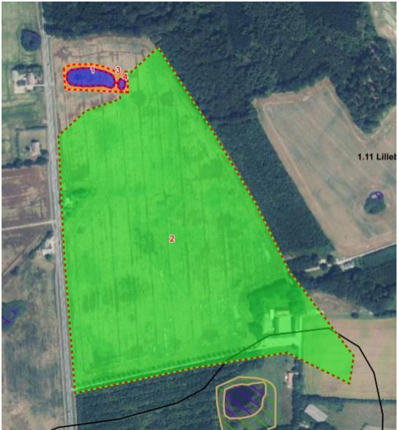
Kortbilag 4. Drænoområdet er markeret med grønt, projektområdet er orange, og minivådområdets vandspejl er blå.
